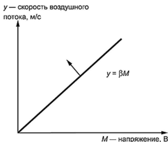
Рис. 3.2 - Идеальная функция системы охлаждения
