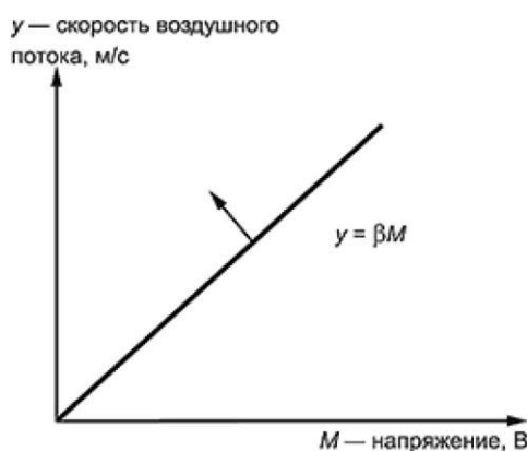
Рисунок 7 - Идеальная функция системы охлаждения
