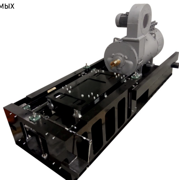
Платформа для проведения испытаний с нагрузочной электрической машиной
